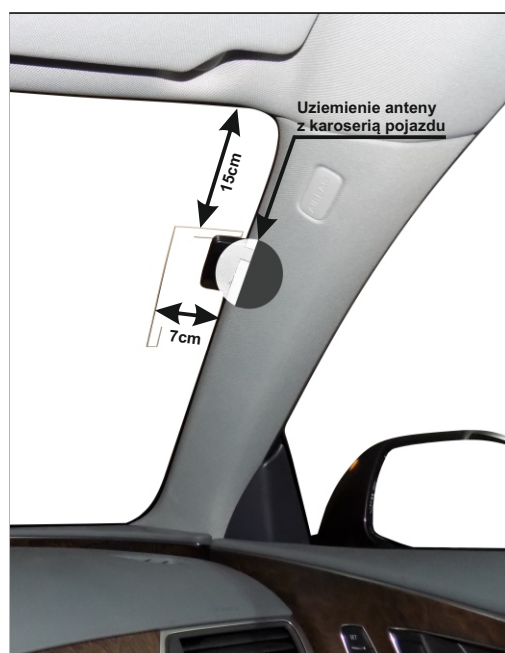
Przykład zamontowania anteny DAB/DAB+
