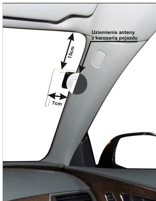
Przykład zamontowania anteny DAB/DAB+
