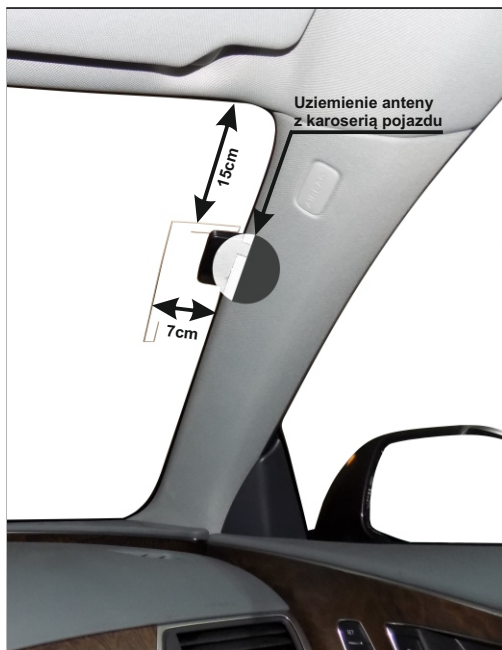
Przykład zamontowania anteny DAB/DAB+
